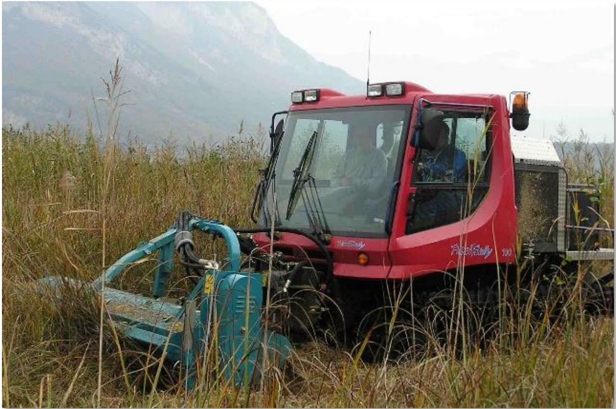
Photo 6. Engin chenillé (Pisten Bully) équipé d'un broyeur pour la végétation capable de traiter des tiges de diamètre inférieur à 30 mm.
